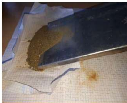
Рисунок 5 – Испытание по определению угла скольжения песка
