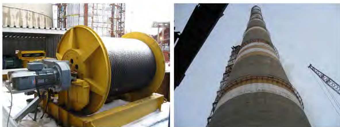
Рисунок 5 - Специальный подъемник для ремонта и реконструкции высотных дымовых труб поставленный на Рязанскую (Новомичуринскую) ГРЭС
