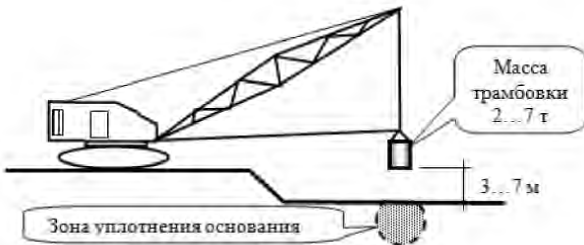
Рисунок 4 – Поверхностное уплотнение грунта
