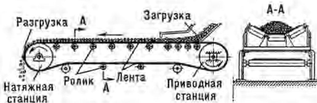
Рисунок 1 - Схема ленточного конвейера с лентой желобчатой формы.
