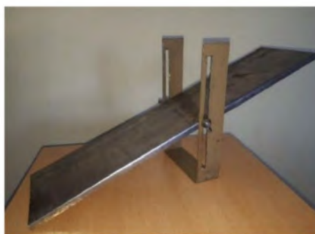
Рисунок 4 – Испытательный стенд для определения угла скольжения пород
