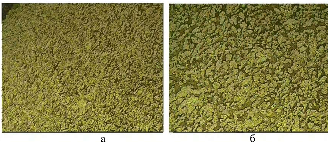
2 сурет - ЛЖМц 66-4-7 маркалы жездің 500°C кезінде деформацияланған үлгілерінің микроқұрылымы (көлденең қимасы): а – шыбықтың шеті (көлденең қимасы); б- шыбықтың ортасы (көлденең қимасы)
