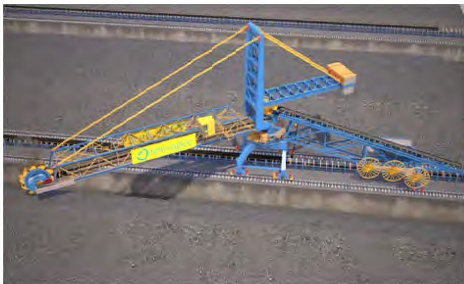
Рисунок 2 - Стреловой роторный стакер-реклаймер
