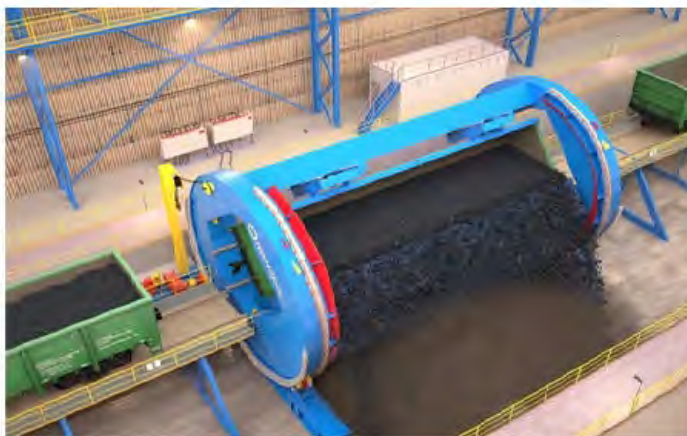
Рисунок 1 - Роторный вагоноопрокидыватель ВРС-75
