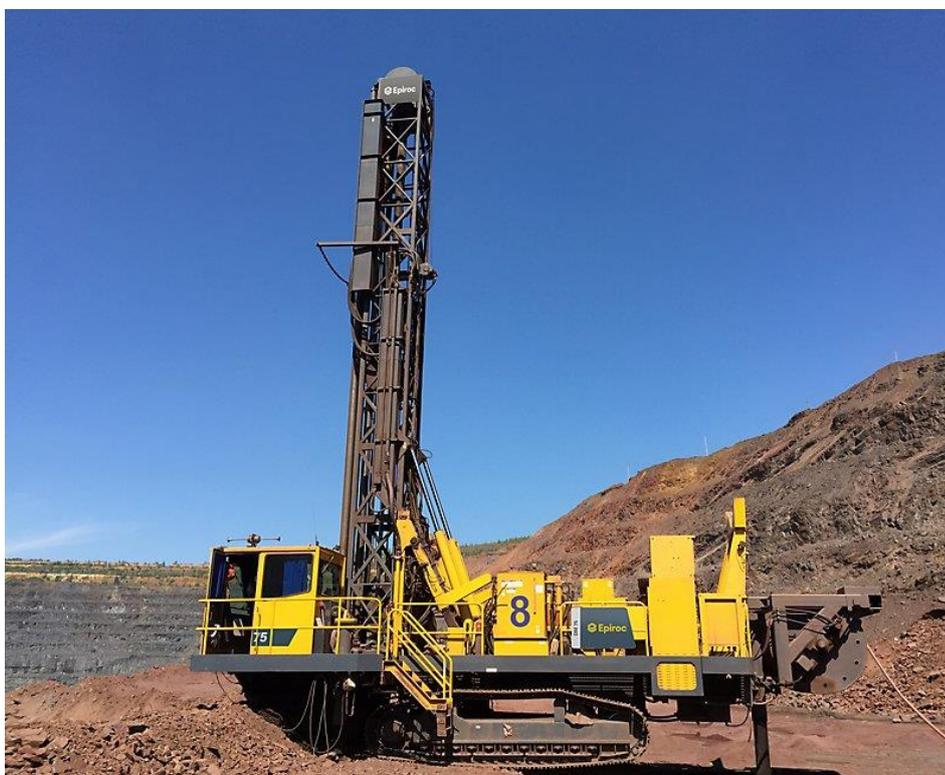
Рисунок 1 – Станок шарошечного бурения ЕPIROC DM75 LP
