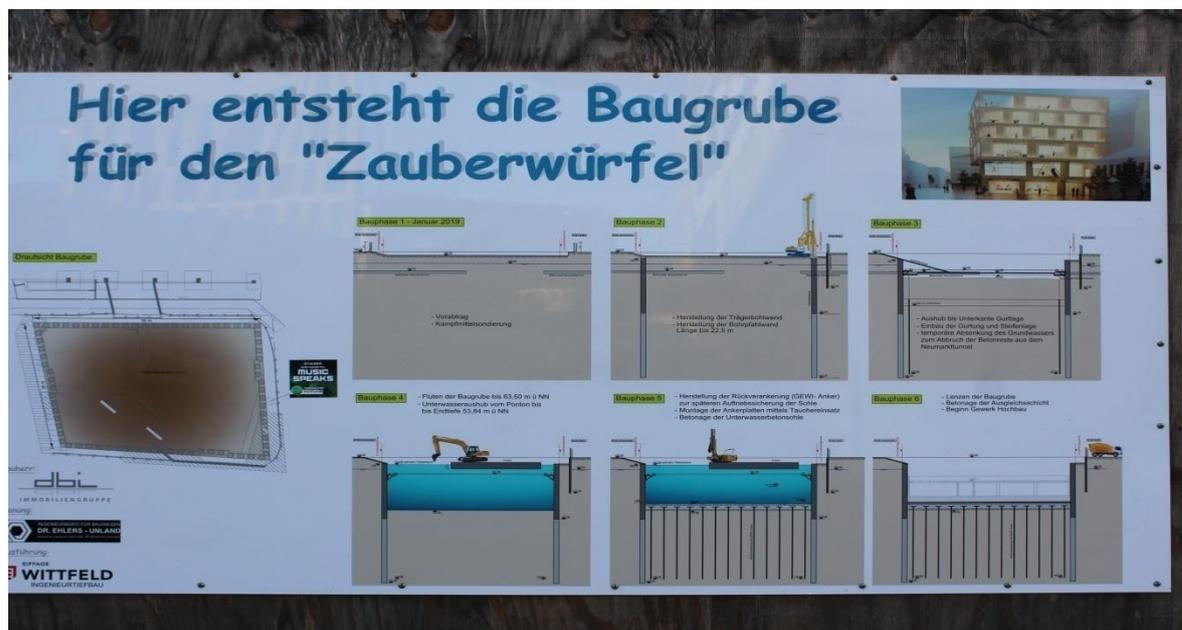
Рисунок 1 – План площадки строительства и этапы производства работ
