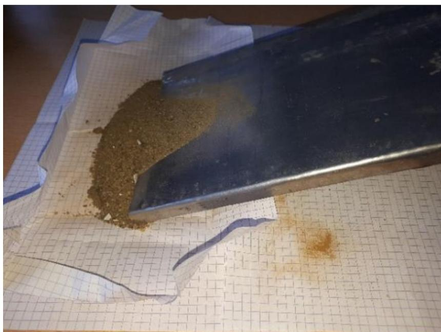
Рисунок 7 – Испытание по определению угла скольжения песка
