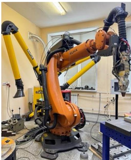
Рисунок 1 – Роботизированная установка KUKA KR120
