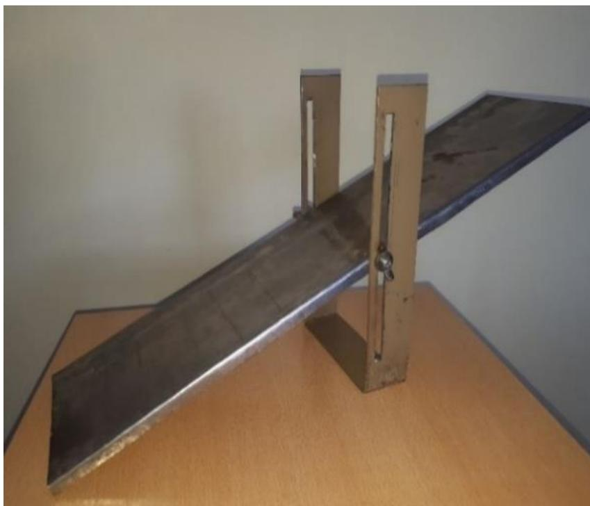
Рисунок 5 – Испытательный стенд для определения угла скольжения пород
