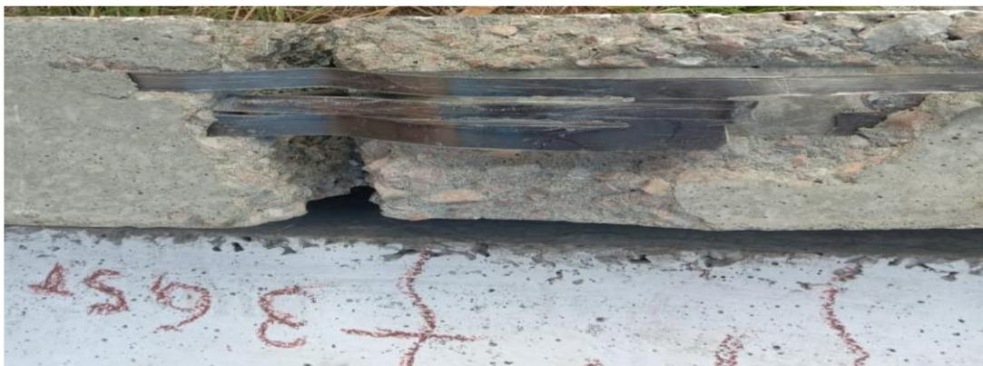
Рисунок 7–Перемычка после разрушения
