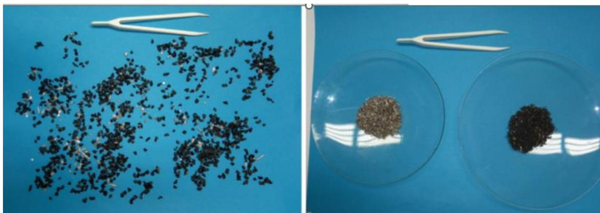
Рисунок 2 – Коксовый остаток и металлическая жила образца
