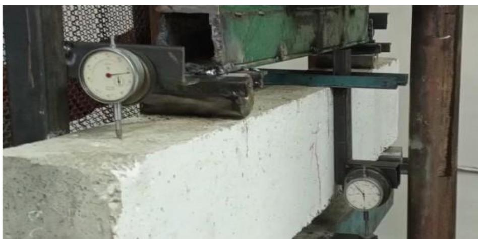
Рисунок 6 – Перемычка перед испытанием
