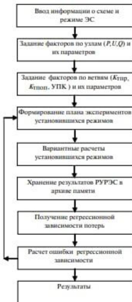
Рисунок 1 – Структурная схема получения регрессионной зависимости
