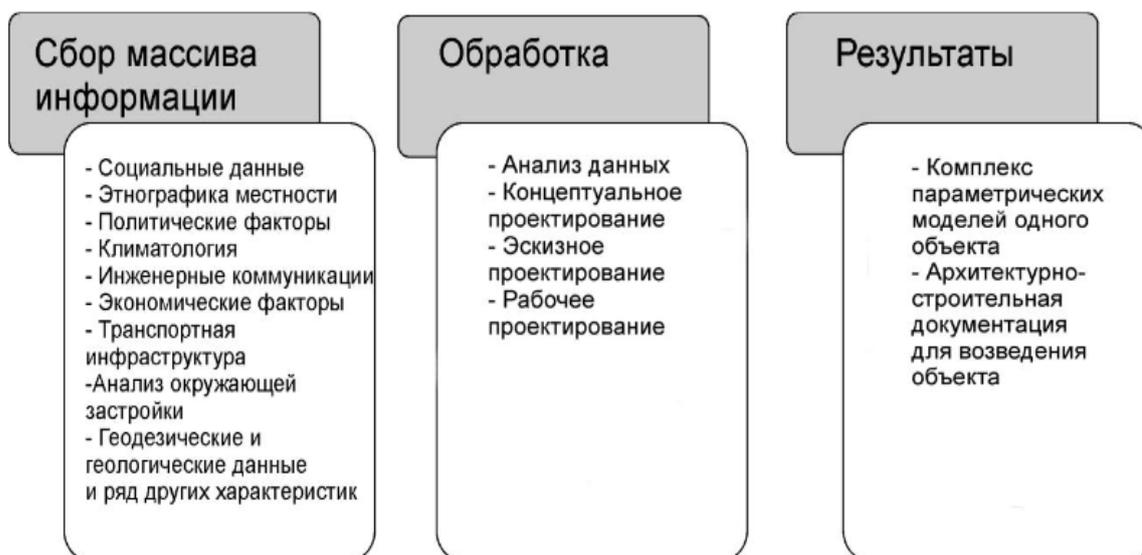
Рисунок 3 – Схема работы параметрического способа проектирования
