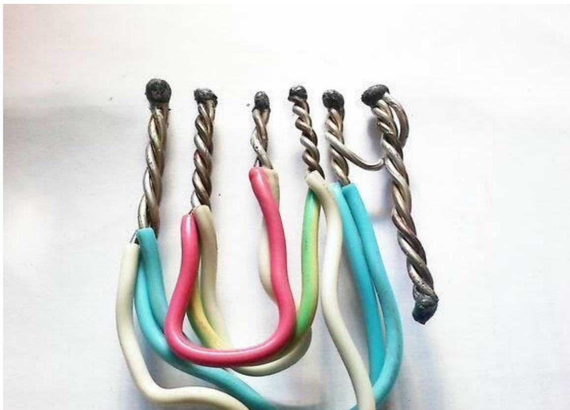
Рисунок 1– Электропроводники из сплава системы Al–РЗМ
