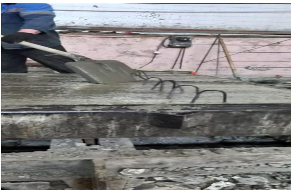
Рисунок 5—Изготовление перемычек на заводе
