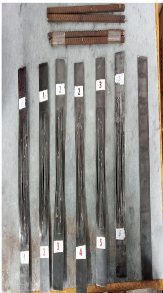
Рисунок 1– Образцы ленты и арматуры для испытаний
